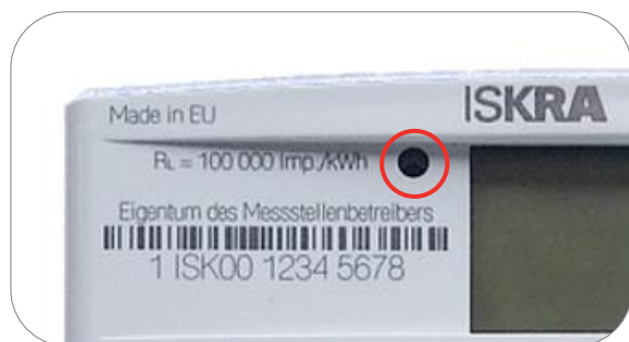
Abbildung 20: Der Standort der LED für die Genauigkeitsprüfung.
