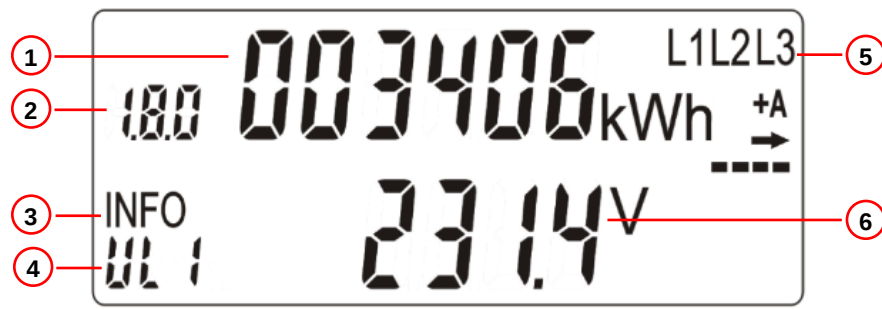
Abbildung 44: LCD-Anzeige im Anzeigemodus „Installationsunterstützung“
