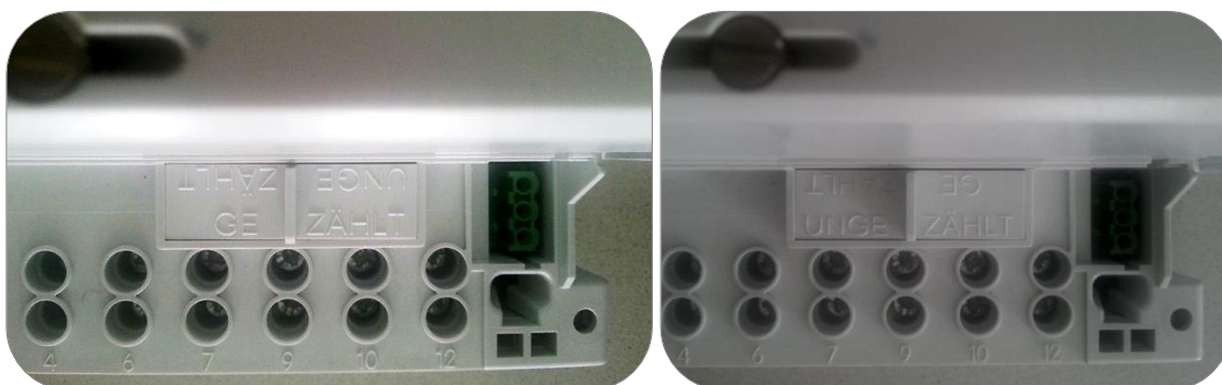
Abbildung 43: Sicherungsgehäuse in der richtigen Position – Positionen „GEZÄHLT“ (links) und „UNGEZÄHLT“ (rechts).
