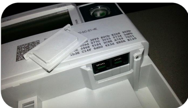
Abbildung 35: LMN-Schnittstelle – Zugang zu RJ-12-Buchsen
