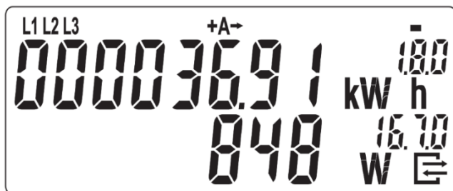
Abbildung 57: Anzeige Register 1.8.0 und Stromausgang
