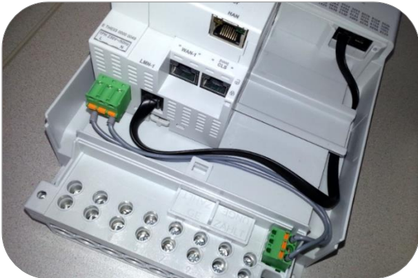
Abbildung 36: Anschluss SMGW an LMN-1 Stecker.
