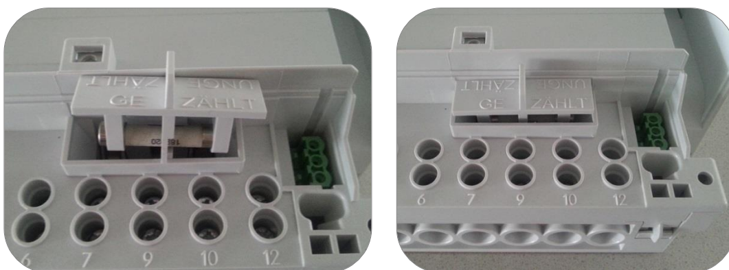
Abbildung 42: Das Sicherungsgehäuse mit der ausgetauschten Sicherung wird in Position gebracht (umgekehrte Reihenfolge gegenüber Abbildung 40).
