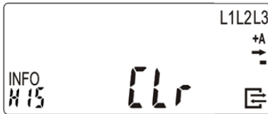
Abbildung 52: Der Modus „HIS CLr“ zum Löschen des Verlaufs der Verbrauchswerte
