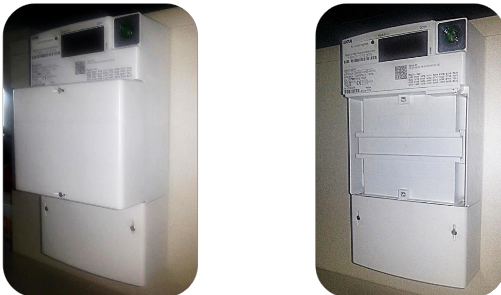
Abbildung 31: Entfernen der Modulabdeckung.
